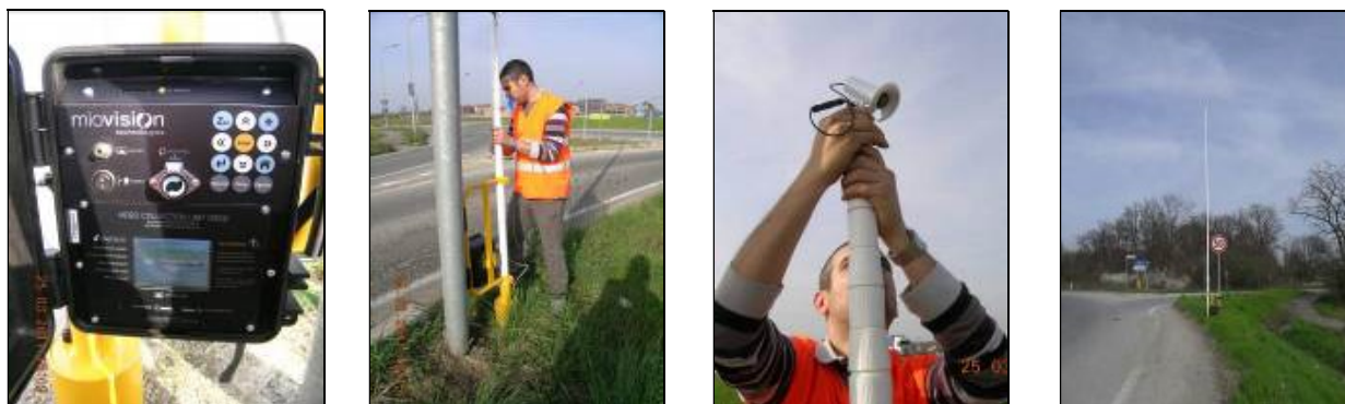
Figura 18 – Esempi di posizionamento del Sistema Portatile di Analisi Video
